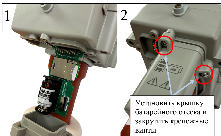
Рисунок 4.3 – Установка крышки батарейного отсека
