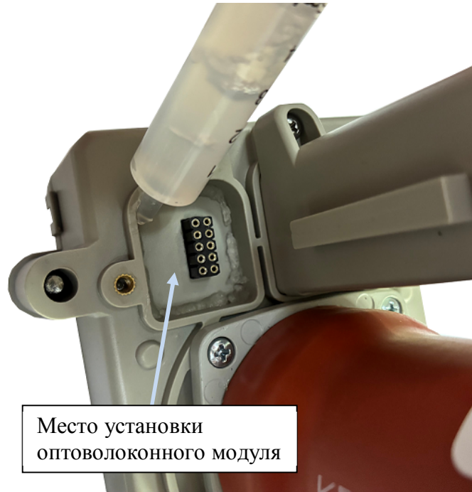
Рисунок 4.9 – Нанесение силиконовой смазки
